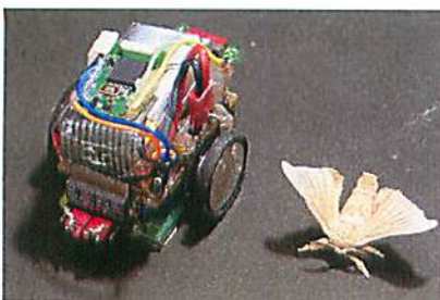
昆虫の行動の仕組み によって制御される ロボット
